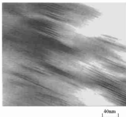
图 3 PP/MMT 纳米复合材料的 TEM 照片
